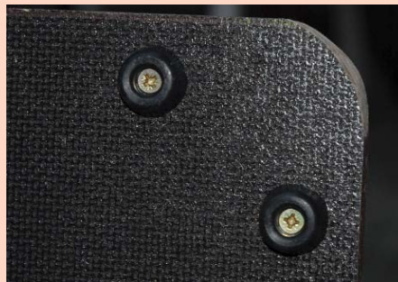
Abb 2: GummifüÙe unter die Bodenplatte schrauben
